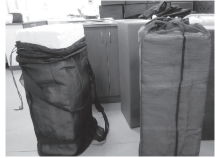
粒子が流出ないように緑色のペイントを塗ったフロート及び網を被せたフロート
