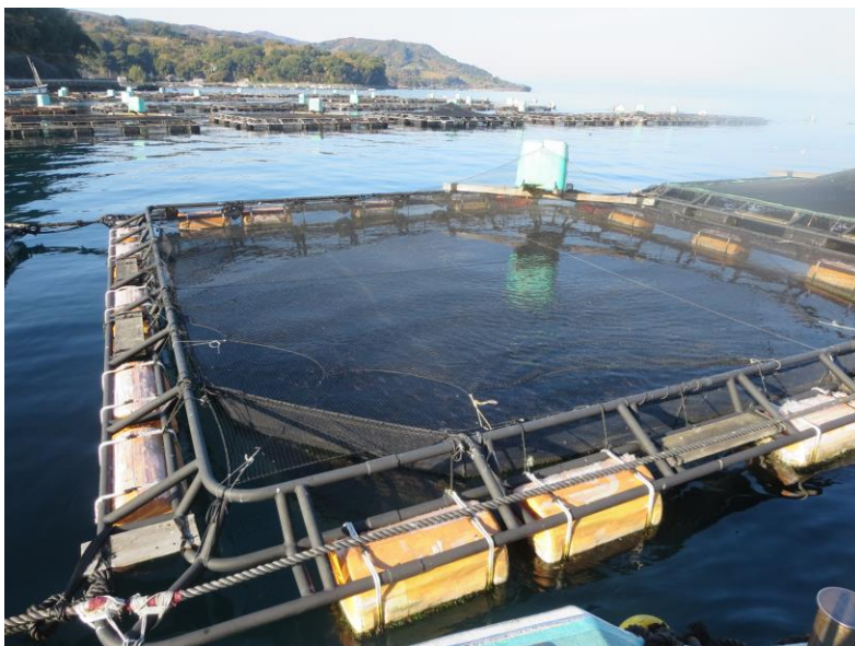
Flotteur moussant (acide polylactique) soumis à un test de vérification dans une cage d'aquaculture
