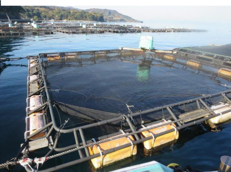
Flotador espumante (ácido poliláctico) bajo prueba de verificación en jaula de acuicultura
