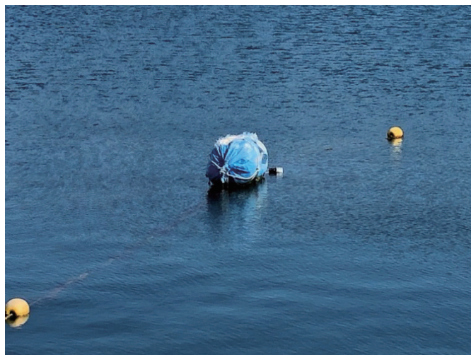
図 3.10 被膜をブルーシートに張り替え、アンカー用のブイとして使用
