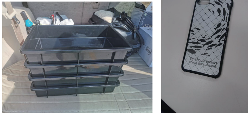
図 2.4 ナイロン製使用済み刺網ペレットを用いて試作した製品 (左：魚箱、右：スマホケース)
