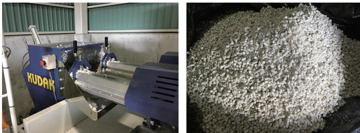
図 2.11 発泡スチロールの処理
