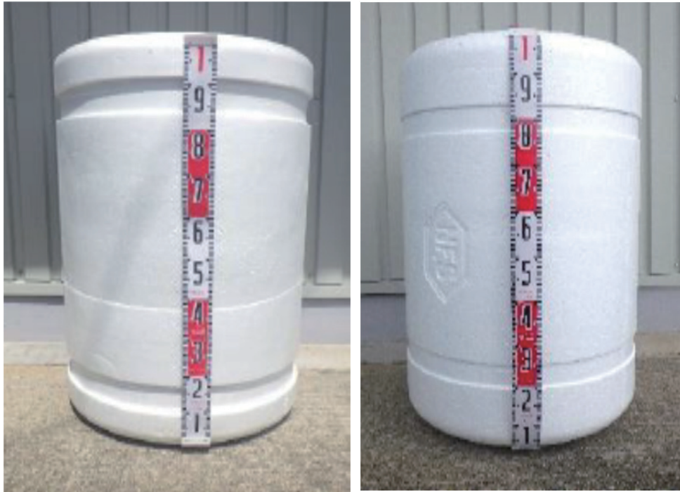
図 3.18 養殖用 PLA フロート（左）発泡スチロール製フロート（右）
