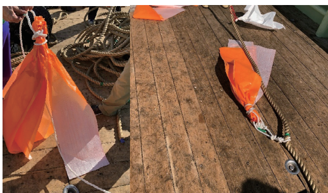
図 3.25 PLA ロープ(テラマックロープ)と PLA シートの垂下物 1.2m 程度に裁断した PLA シートを PLA ロープで結索した。
