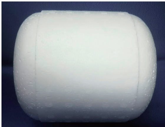
図 3.19 今回作成した FADs 用フロート 長さ 200mm×直径 180mm の円柱形 空中重量 165g、推定浮力 4.8kg
