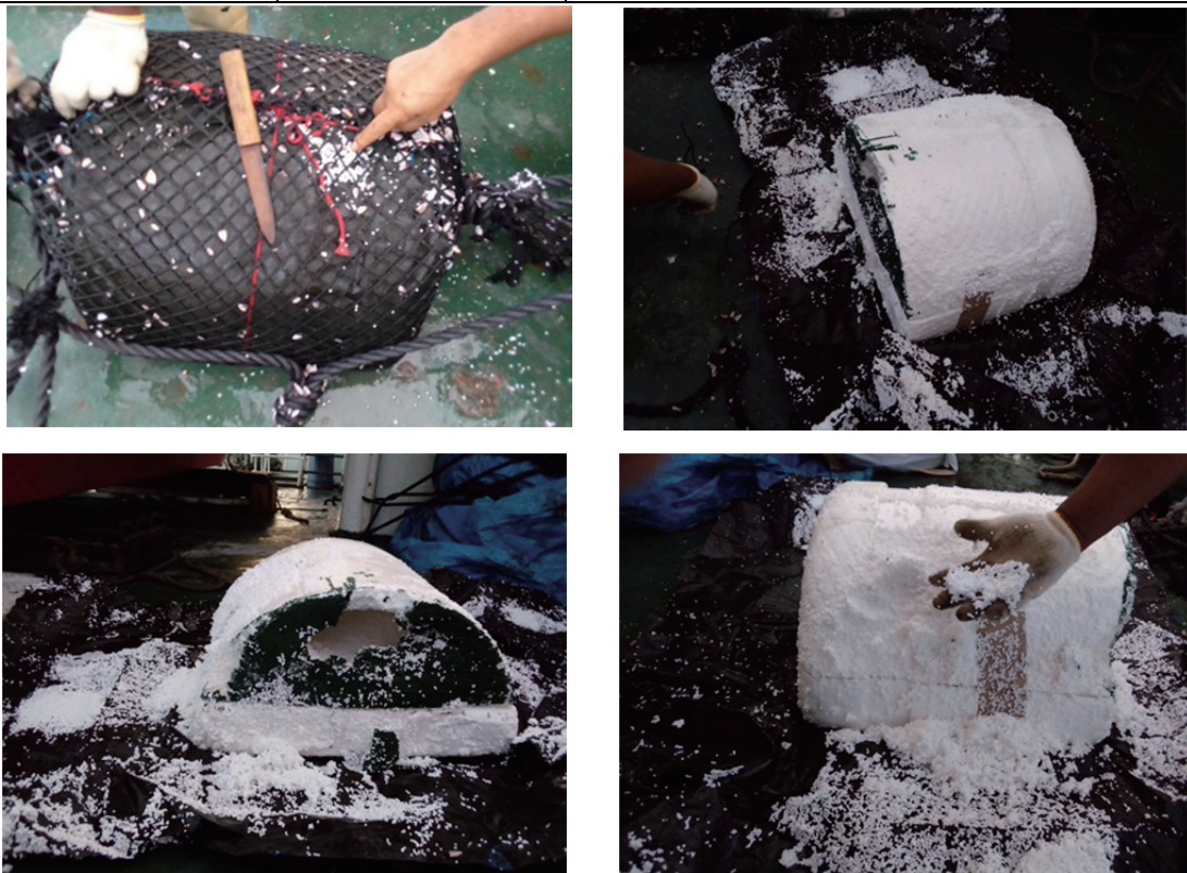
図 3.33 回収した浮子の外観およびを分解して、養殖用 PLA フロートを点検した様子
