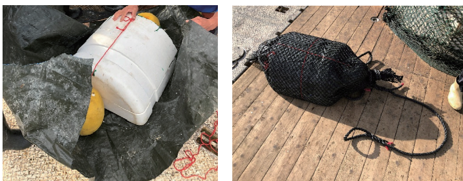
図 3.24 養殖用 PLA フロートを用いた浮子 半円柱の長辺を 2 等分もしくは 3 等分に切断した。
