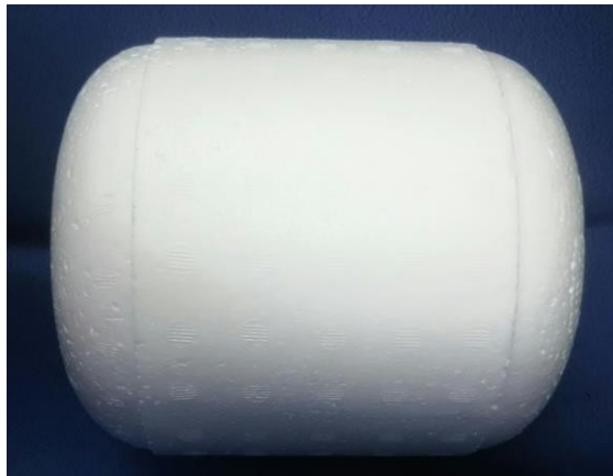
図 3.9 今回作成する FADs 用 PLA フロートの写真
