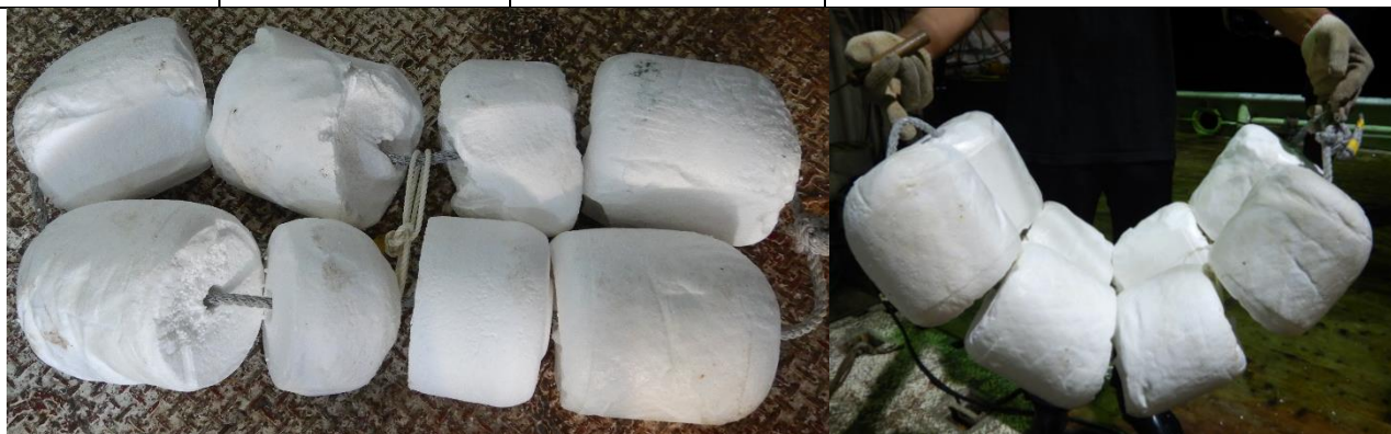
図 3.17 隣の浮子と接触している湾曲部分の摩耗が著しい
