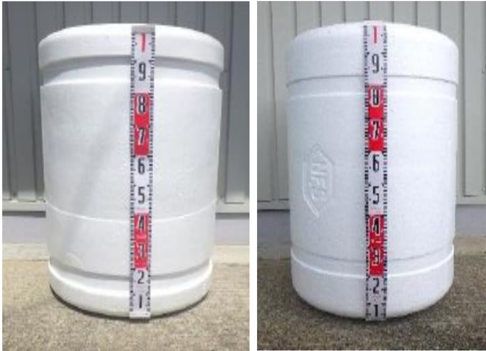
図 3.8 養殖用 PLA フロート（左）発泡スチロール製フロート（右）
