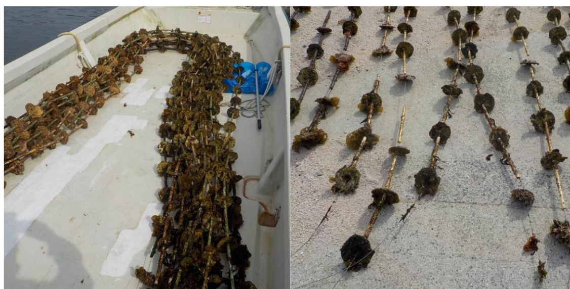
図3.3 回収したカキパイプ(海水浸漬3ヶ月、左:船上、右:岸壁)
