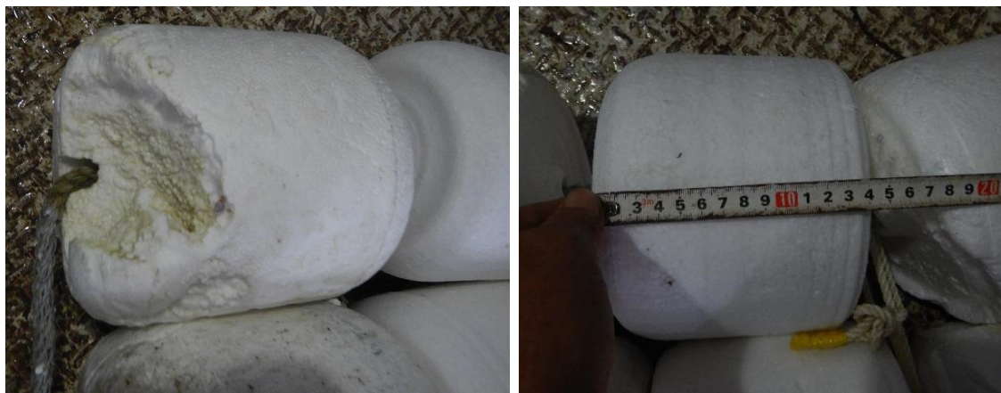
図 3.19 外的損傷箇所あり。長さ 18cm が 14cm まで摩耗している状態
