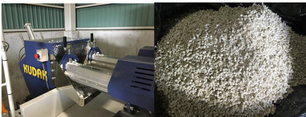
図 2.6 対馬市が導入している発泡スチロール減容化装置(右)とペレット化された発泡スチロール(左)
