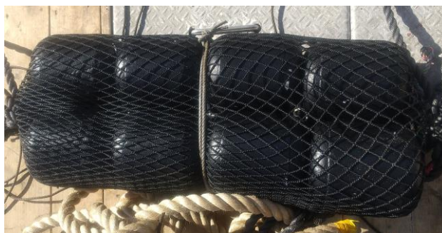
図 3.21 新品の PLA フロートに黒ペンキにて表面を塗装 PP シートで被わず直接網地で固縛して放流。紫外線の影響を調査する予定。
