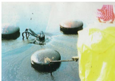
写真23 堰式装置による回収
