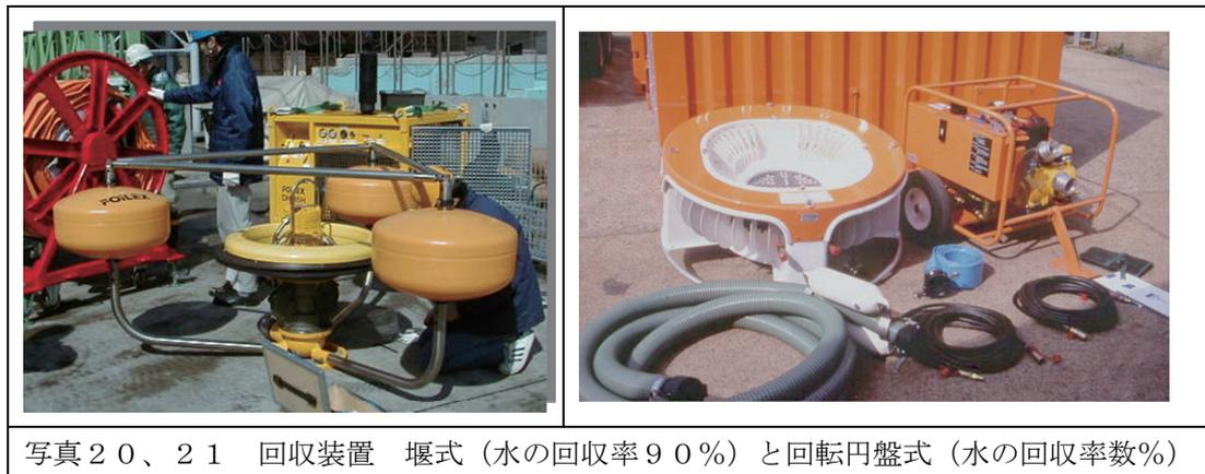
写真 2 0、2 1 回収装置 堰式（水の回収率 9 0 %）と回転円盤式（水の回収率数 %）
