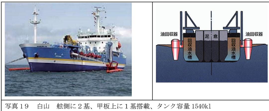
写真19 白山 舷側に2基、甲板上に1基搭載、タンク容量1540kl
