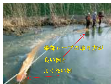
写真3 BT型、流速90cm/sの状態(15φ×20cm)10m使用 OFは堰を作り、川水が浮体の上から流れ落ちた。両端ロープ張力は強大となる。(反省点→手前端部ロープを水面より1m程高い位置に固定してしまった→低位置からとる) (急流で一時的に堰として利用ができることが判った)
