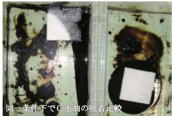
写真5 油吸着材 重油の吸着状況比較
