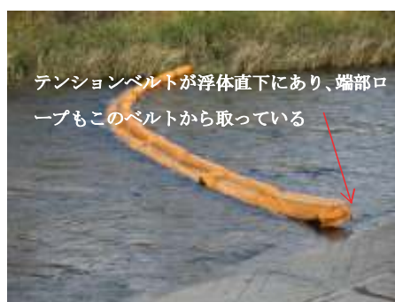
写真1 既存のB型OF20m 流速60cm/s(10m間の木片移動時間から計測) テンションベルトを境にスカート浮上 これでは適切に目的を果たしているとは言えない。
