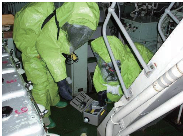
事故船内の漏洩ガス検知
