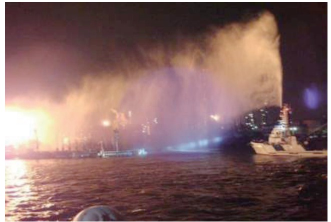
写真2 風にのせて放水を霧状化し、冷却効果を高めて火炎を縮減する消防戦術（消防船おおたき）
