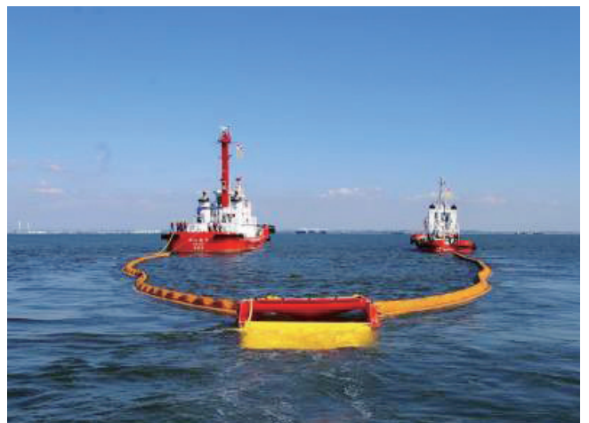
写真 16 集油型薬剤散布装置
