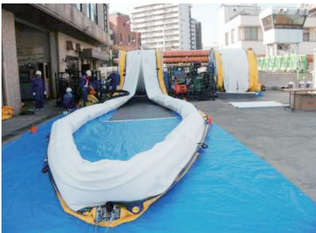
写真 15 耐火オイルフェンス
