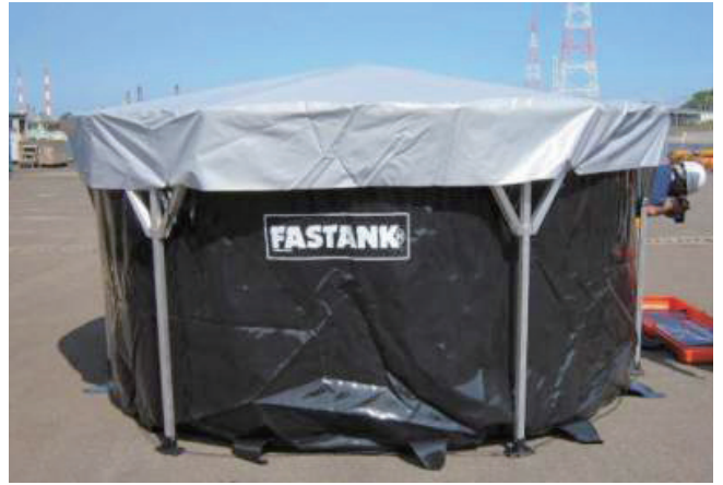
写真 14 一時貯蔵タンク
