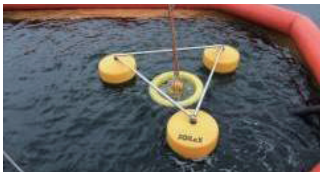
写真11 中型油回収装置（堰式）
