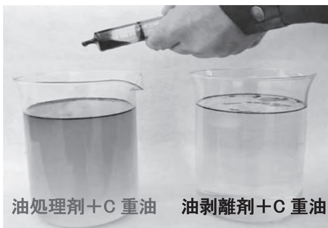
図2 左：油処理剤+C重油 水中に油が分散 回収不可 右：油剥離剤+C重油 水面上に油が浮く 回収可能
