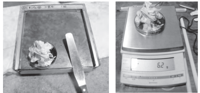
図16 洗浄後に残留した油の量の測定
