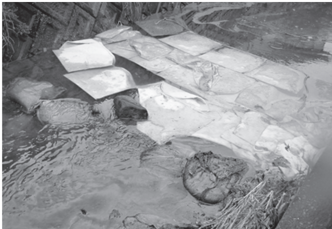
写真9 油吸着材 OF、簡易堰と併用すると効果が上がる 飽和状態ではなく、油膜が薄いため吸着せず素通りしている
