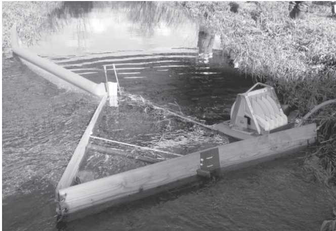
写真8 充気式オイルフェンス・V型簡易堰・回収装置の組み合わせ 川幅 5m、水深 5~20cm 流速 25cm/s 回収装置は小型回転円盤方式 (油分を90%台で回収できる動力 AC100V 電源から)
