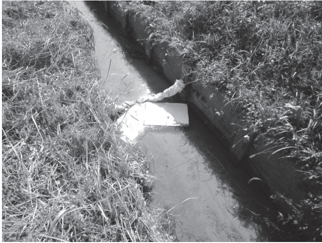
写真5 水路に設置されたオイル吸着マット 薄い虹色の油膜を吸着できずにマットより下流側に油膜が流出している
