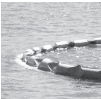
写真9、10 平成26年横須賀訓練所沖、TTとBTのU字曳航 底部の状態 0.5ノット
