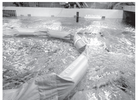
写真11 平成29年9月、横浜防災基地水槽 B型TT20m、流速80cm/s
