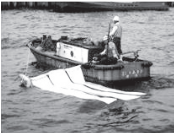
【画像5：ロール型油吸着材による吸着材曳航回収】
