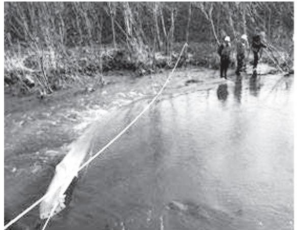
写真8 平成21年11月形須別途川 流速90cm/s 浮体が水面下になり、水位差10数cmの堰となっている
