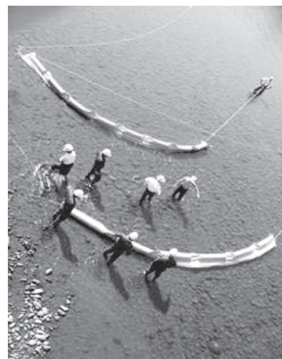
写真4 平成20年9月 試作したOF (ボトムテンション) と現行の海用B型OF (トップテンション) の対比実験
