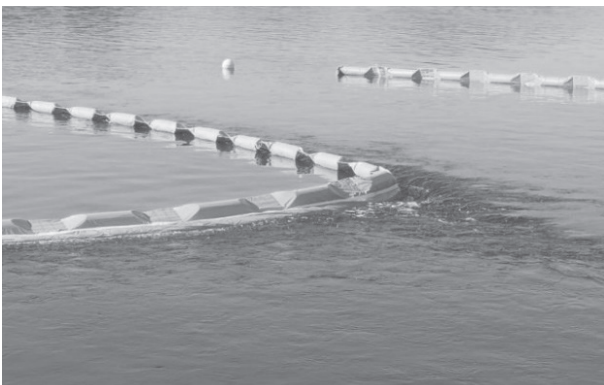
写真12 曳出し直後のスカートの状況
