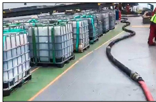
写真5 W号上甲板に仮置きされた燃料油保管用の小型タンク
