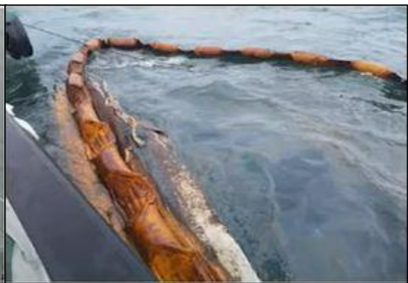
写真6 吸着材 (OF型) による回収 出典：災防センター
