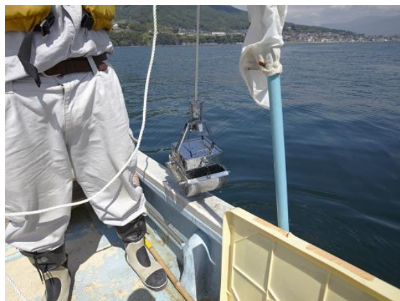
図4 大船渡湾におけるエクマンバージ採泥器による底質の採取作業
