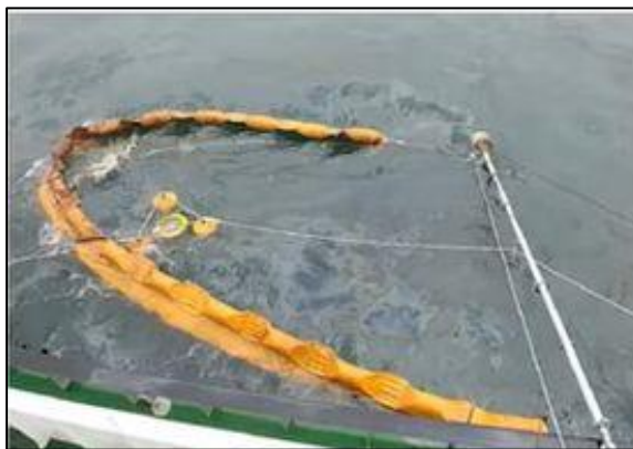
写真5 OFのU字展張と回収装置による回収 出典：災防センター
