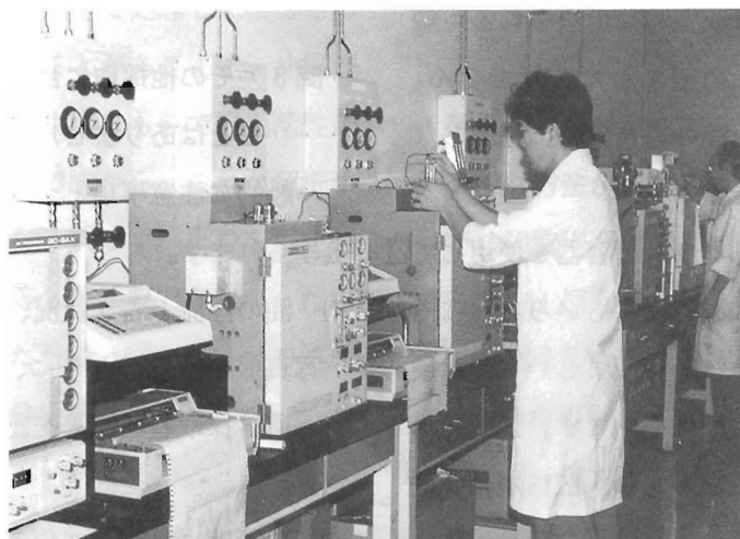
ガスクロマトグラフによる油の分析
