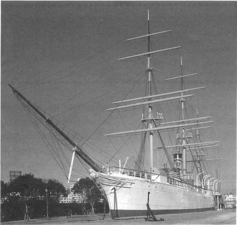
明治丸は現在、重要文化財として東京商船大学の構内に保存されています。 (総トン数： 1,03 1037 トン、長さ：73.8メートル、幅：8.9メートル)
