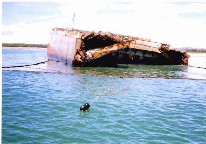
鹿児島県志布志湾で座礁折損した大型運搬船
