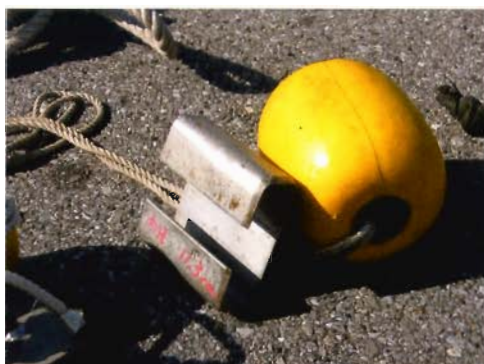
写真2 スライディングジョイント使用時の油吸着材用フロート
