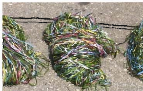
*1 オイルスネア ポリプロピレン製の紐を束ねたもので高粘度油に対応する。
