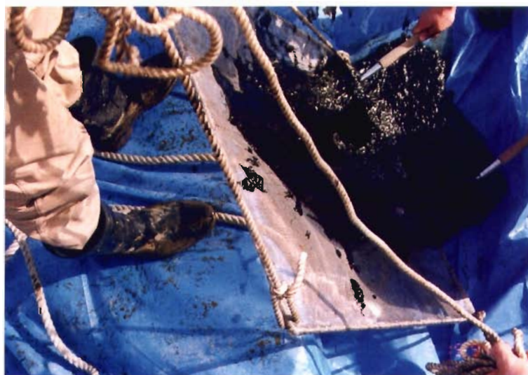
写真1 小型回収枠用金網を利用した高粘度油の回収（講習会時の写真）
