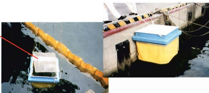
図2 小型油回収枠
