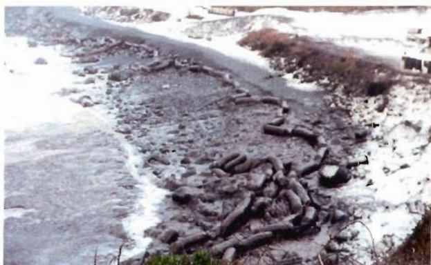
写真4 破壊されたOF 荒天の影響を直接受ける海域で使用されたため、展張の後海岸に打ち上げられた。
