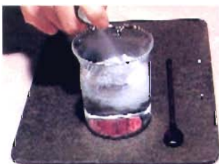
海水と反応して白濁する油処理剤
