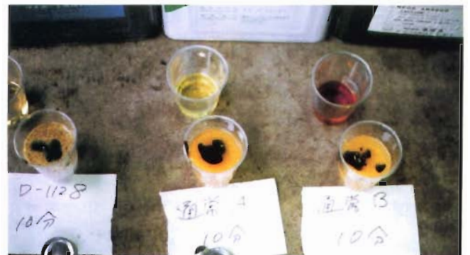
写真15 マッチングテスト（平成9年1月ナホトカ）現場でサンプリングした油と海水、3種類の油処理剤で分散性のテストを行った。結果は分散しなかった。
