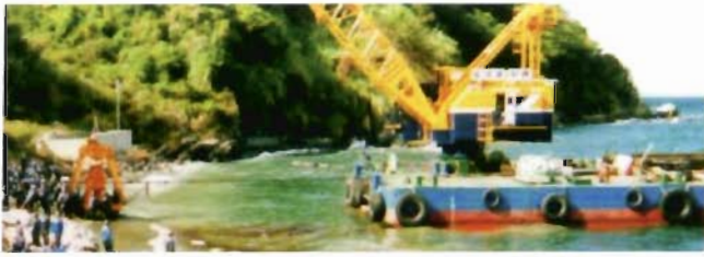
写真17 グラブ船による回収 船首部噴水60cm、クレーン長さ20m、平グラブ6 m 3
