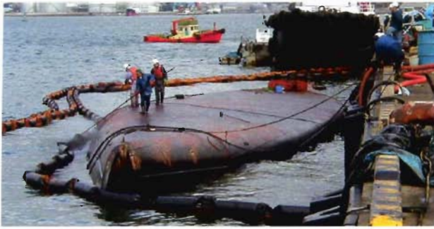
写真3 流出源に展張（港内） 転覆したタンカー周囲にB型OFが二重に展張され、油の拡散を防止、その後機械で約100トン回収。 OFは初期に展張されたが、岸壁との間に隙間があったため一部漏れた。
