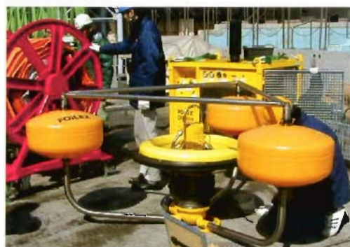
写真9 堰式回収装置
