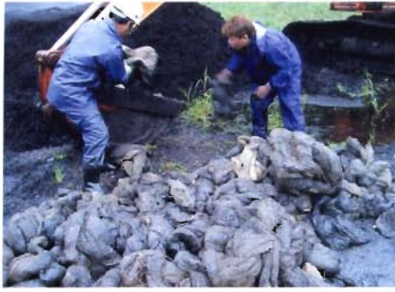
広島廿日市港で油を吸着した「杉の油取り」をバーク堆肥に入れて分解実験する様子
