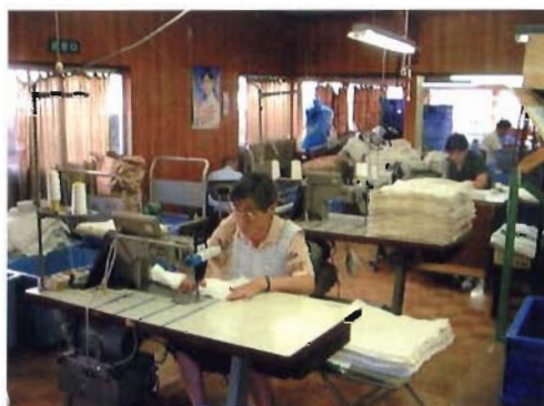
授産施設での杉樹皮製油吸着剤の製造（縫製）
