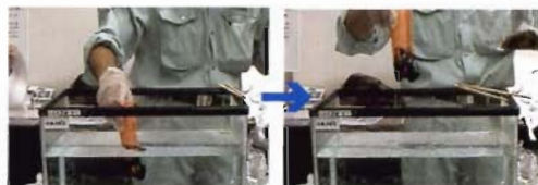
油回収ネットを使った油回収実験
