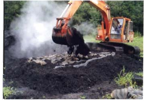
広島廿日市港で油を吸着した「杉の油取り」をバーク堆肥に入れて分解実験する様子
