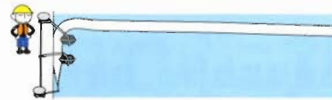
折り返した油回収ネット等に重錘付きロープを設置し岸壁に密着させます。
