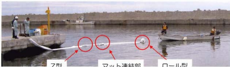
油吸着マットを小型船が曳航している様子
