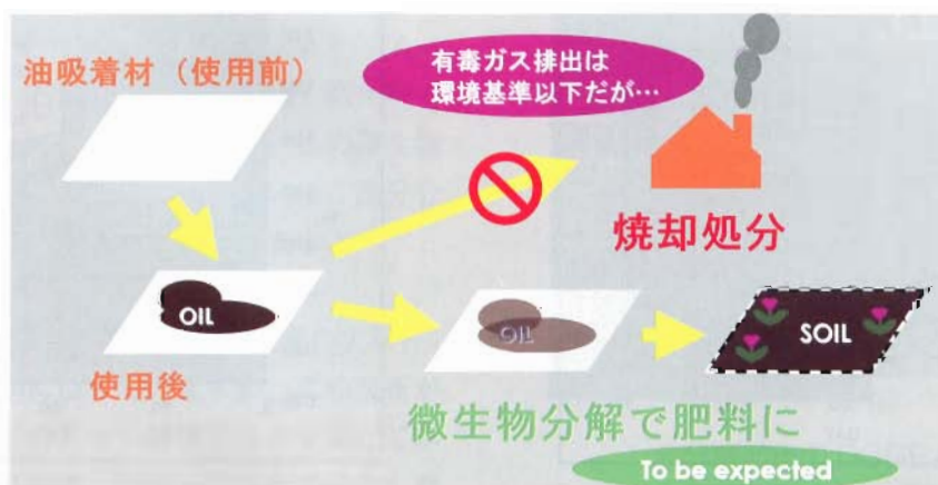
油吸着材の微生物分解処理の概念
