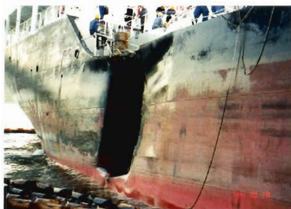
写真2 TO丸の衝突痕 相手船舶首部が船尾部タンクにめり込み1タンク分全量が流出した
