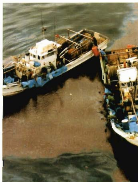
写真4 沖合での回収 柄杓使用 (NA号)
