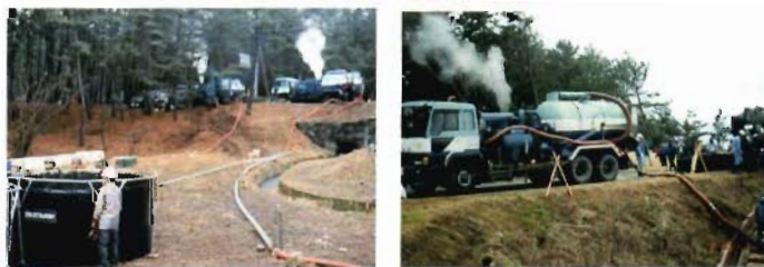
写真10 強力吸引車 竜巻流で吸引するため、高低差20m、水平100m程度は容易に油を回収。
