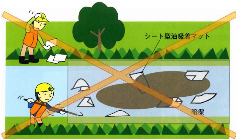
図2 行ってはならない防除方法（暗渠に入り込んだシート型油吸着マットは回収が困難）
