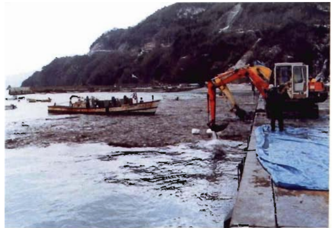
写真10 岸壁から重機による回収
