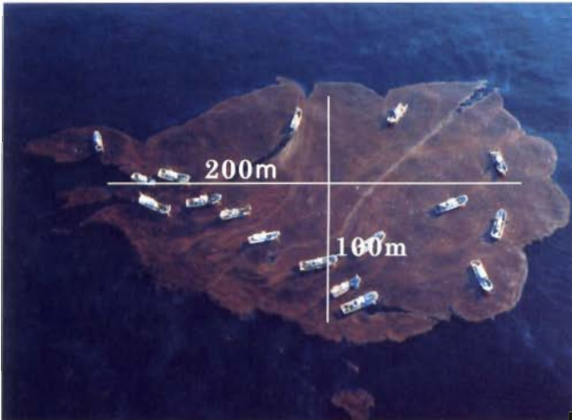
写真9 13日猿山岬沖で回収に当たる輪島の漁船 漁船の寸法から油塊の大きさは概200×100mと推測した
