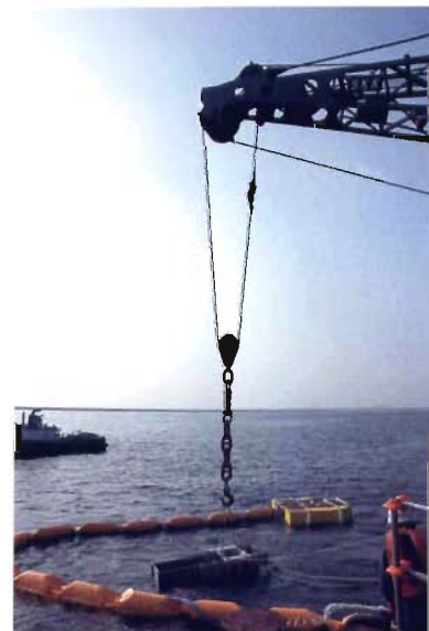
図8 工事用作業船を油回収船に転用するシステム
