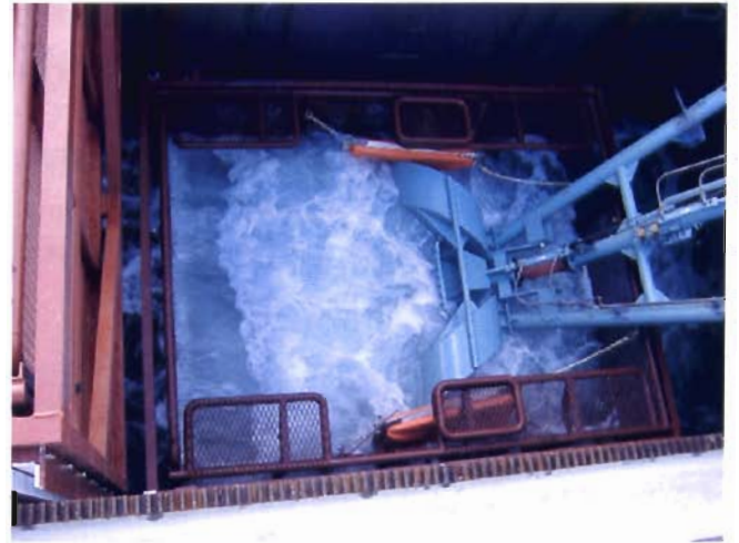
図4 「いしづち」の真空吸引式油回収機ヘッド
