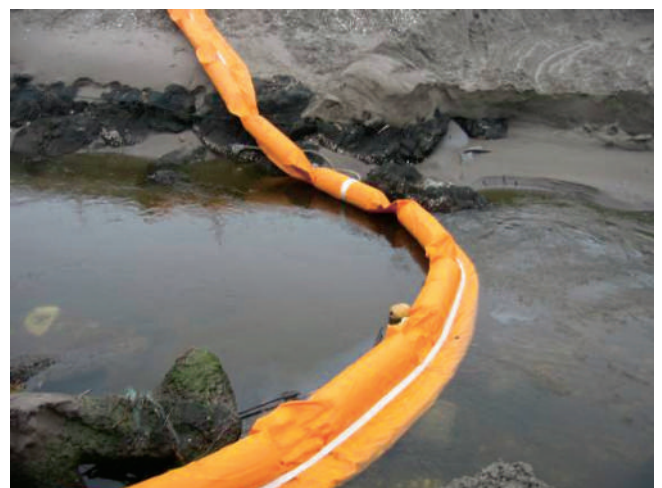
写真12 油は水路から水門を経て南部陣屋川へ B型OF3通りに地元消防により展張
