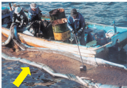
オイルスキミングネットで集めた油を回収 (H14年、伊豆大島)
