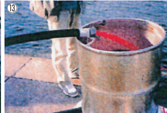
写真13 厚い油層の表面油をエアポンプで水面下へ吸引して回収。
