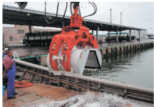
甲板上で油回収バケット内に取り込んだ海水を排出する
