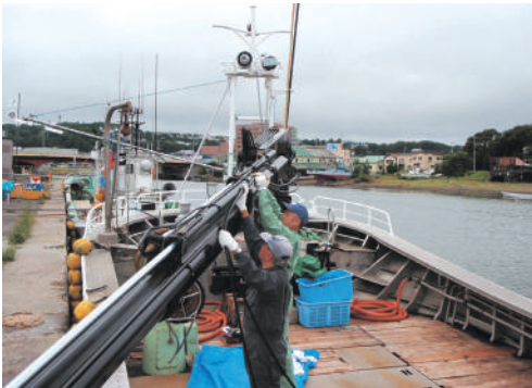
油圧ホースの整備
