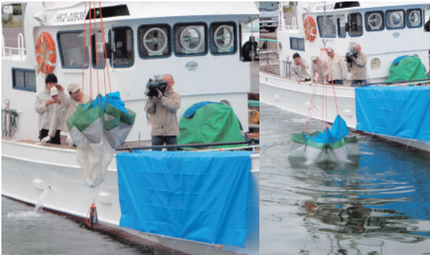
タモ型を水中へ沈める。 タモ下部の鍾は海面の油を切る役割をする。
