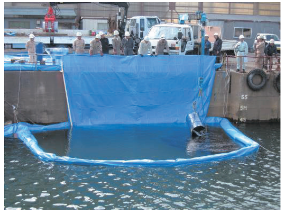
実験海面にC重油投入
