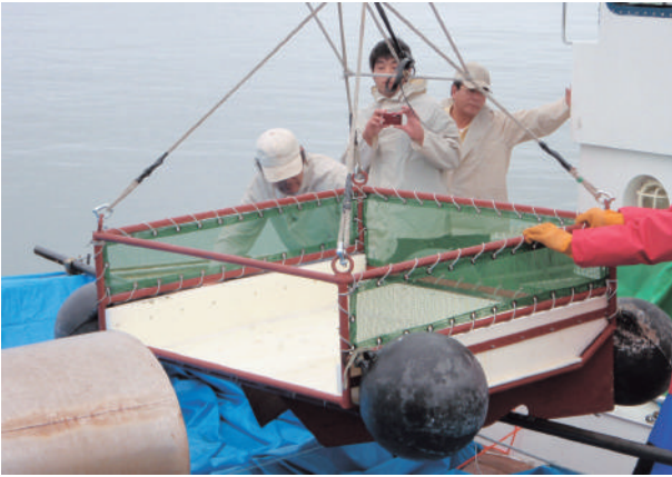
船上へ 甲板上ではトンボで取り込んだ油をかき出す。
