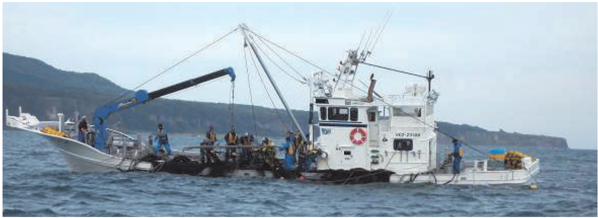
サケ定置網漁船 揚網中 ユニックとポンプを使用している
