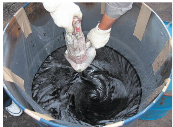
攪拌器で海水とC重油を攪拌
