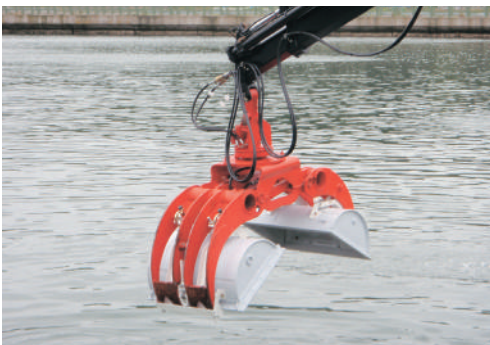
クレーンを海面に伸ばし油回収バケットの口を開く
