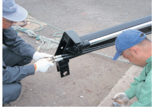
油圧ホースの増設
