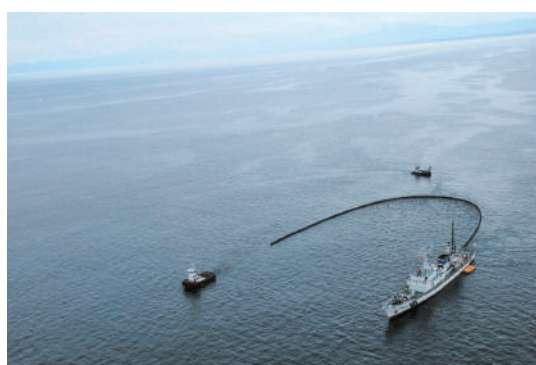
「中型油回収装置」油回収訓練（Jフォーメーション） （巡視船そらち、作業船益栄丸）
