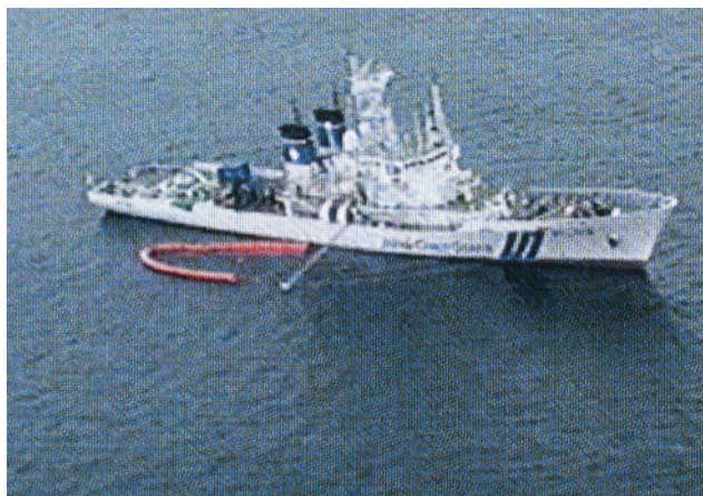
「大型真空式油回収装置」運用中の巡視船えりも
