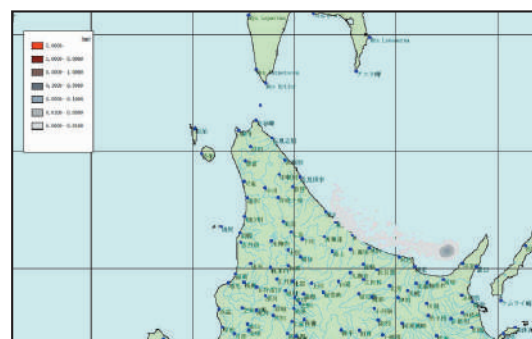
油の漂流シミュレーション結果 冬季(12月) 流出位置 宗谷海峡中央 流出量 21,000kl 流出後5日目
