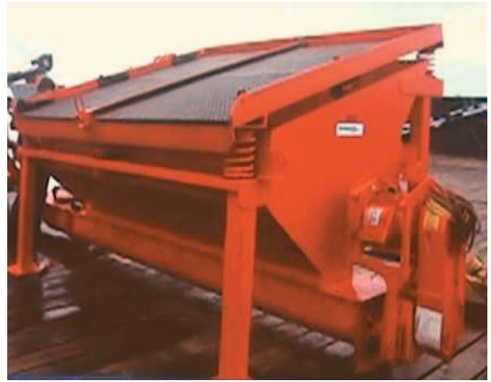
大規模な油性砂トリートメントシステム 大型の油性砂洗浄選別機（能力：40～50ton/h）をシステムチックに使用 BP資料より抜粋
