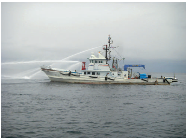
写真3 流出油の拡散作業
