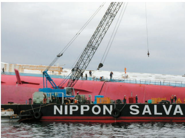
写真2 燃料油の抜き取り作業
