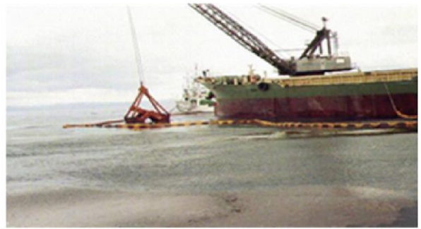
図3-7 タンカー豊孝丸から流出した油の回収 バージ土倉300m 3 2隻に投入
