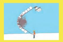
港内で岸壁の近くに油が 浮遊している場合に、船 舶1隻で回収する方法。
