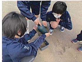
②3班に別れ、それぞれ海岸の3箇所から砂を採取します。まず、5mmのふるいで大きなごみなどを取り除きます。
