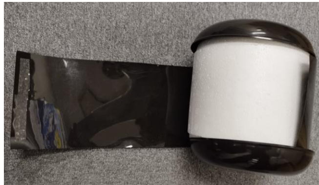
図 3.7 R4-3 型、R4-4 型フロートのカバー取り付け方
