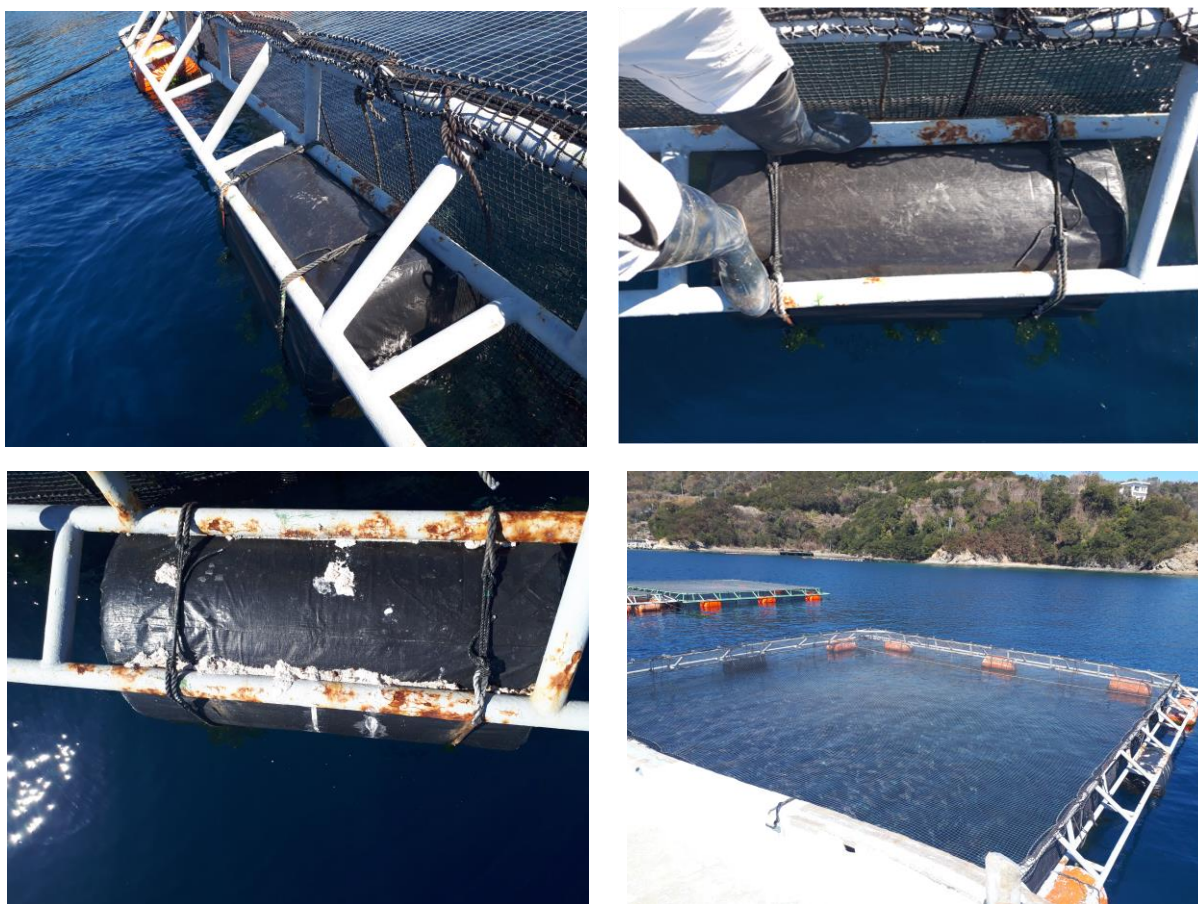
図 3.5 試験中のポリ乳酸フロート(黒いカバー)の様子(令和5年2月27日現在)
