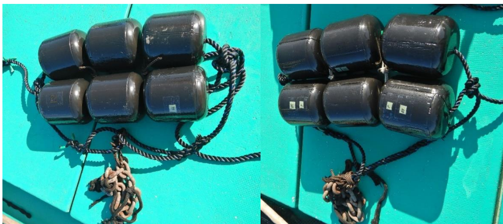
図 3.15 耐久試験を行う FADs 浮体(左 : R4-3、右 : R4-4)
