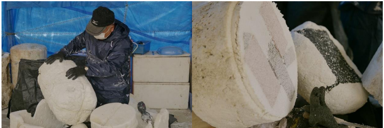
図 2.9 発泡スチロールを破砕する前処理 (左) 異物確認 (右) フロートに混ざる異物
