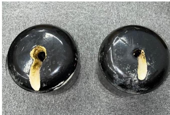
ロープを外した状態(フロートの変形を確認できる)
