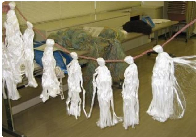
写真 15 吹き流しタイプの油吸着材
