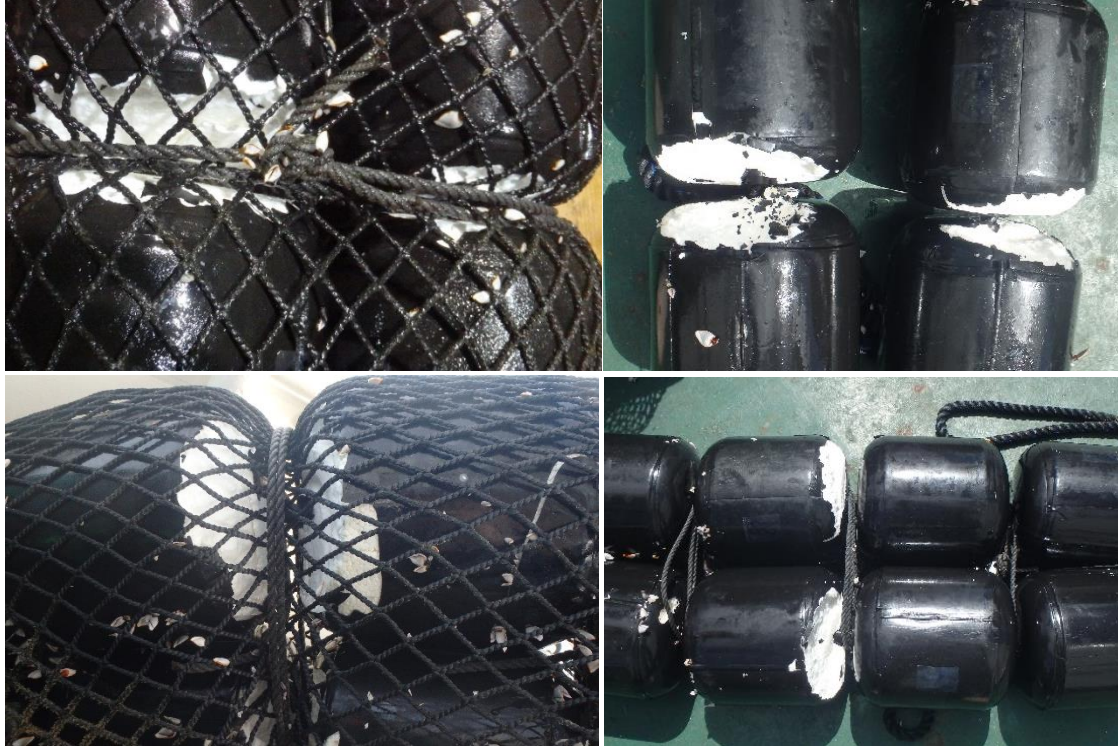
図2-1-10 漂移日数54日と漂移日数55日の外観と破損状況
