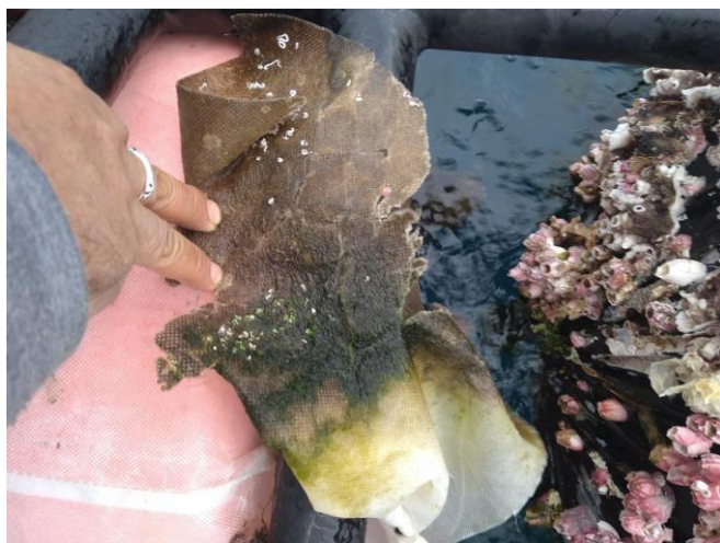
図 2-2-7 崩壊したフロートカバー
