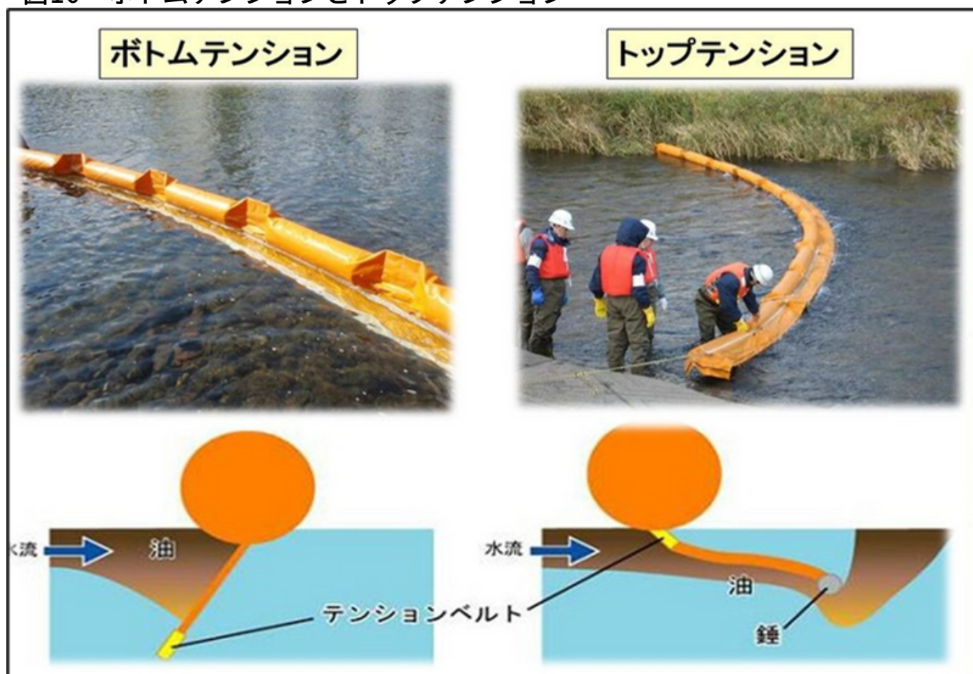
図10 ボトムテンションとトップテンション
