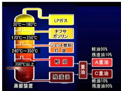
図2 石油精製のしくみ
