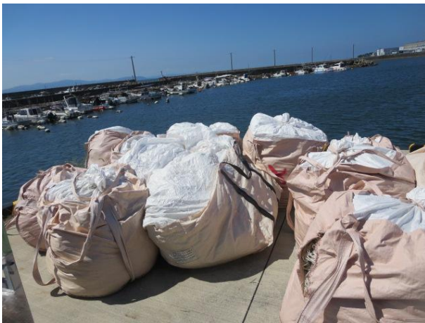
図 3-4.5 破碎された使用済み漁網はフレキシブルコンテナに入れて保管した。
