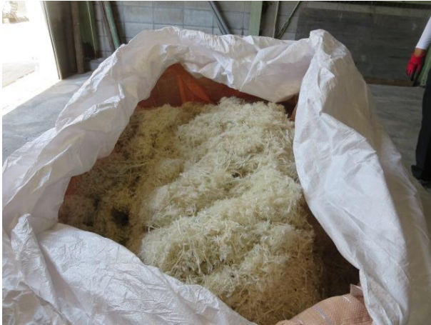
図 3-4.4 破碎された使用済み漁網
