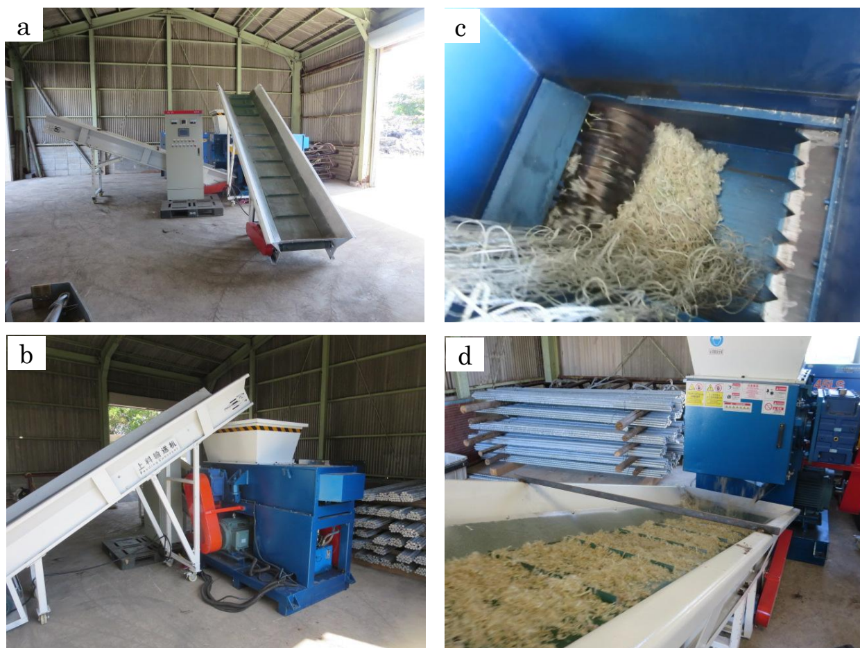
図 3-3 今回の実証試験に用いられた破砕機の写真(a:ベルトコンベアー、b:破砕部へ投入する部分、c:破砕部の中、d:破砕された使用済み漁網)
