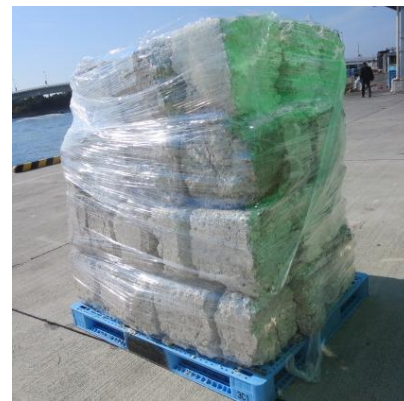
発泡フロートを圧縮処理。容積を1/30に圧縮し、燃料ペレットの原料にリサイクル
