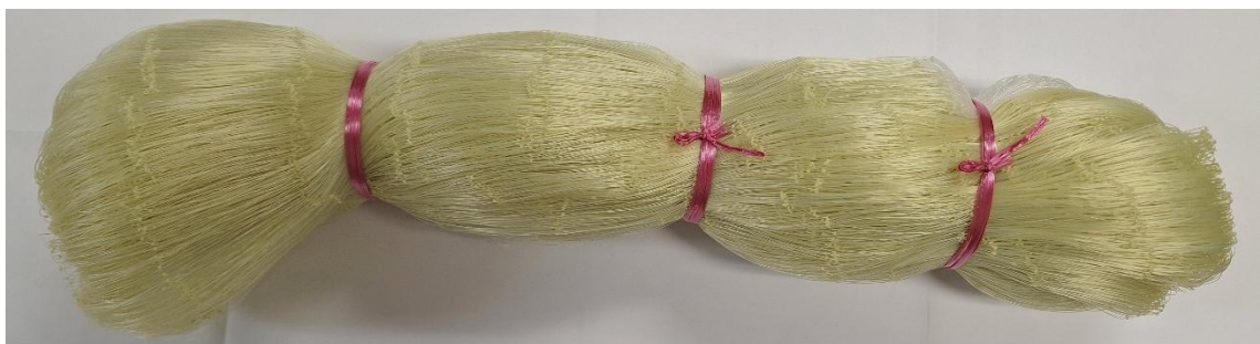
図 2-4-3 海洋生分解性ポリエステル製モノフィラメント刺網
