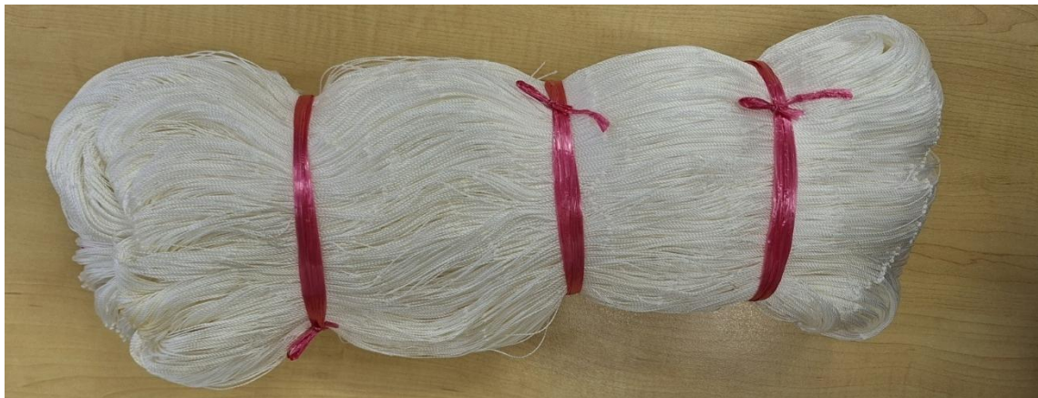
図 2-4-2 PLA 製マルチフィラメント刺網
