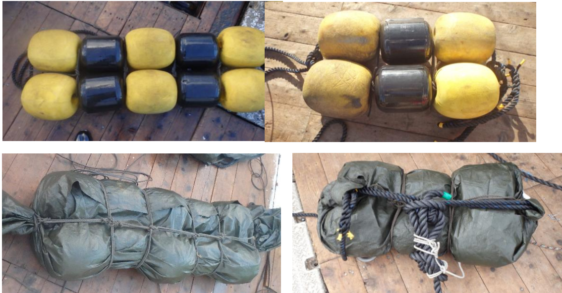
図 2-1-6 PP シートでカバーをして使用したエコ FADs の浮体 左上段：R5 型 PLA フロート 4 個と EVA フロート 6 個を使用した浮体 右上段：R5 型 PLA フロート 2 個と EVA フロート 4 個を使用した浮体 下段：上段の組み合わせを PP シートで覆った浮体
