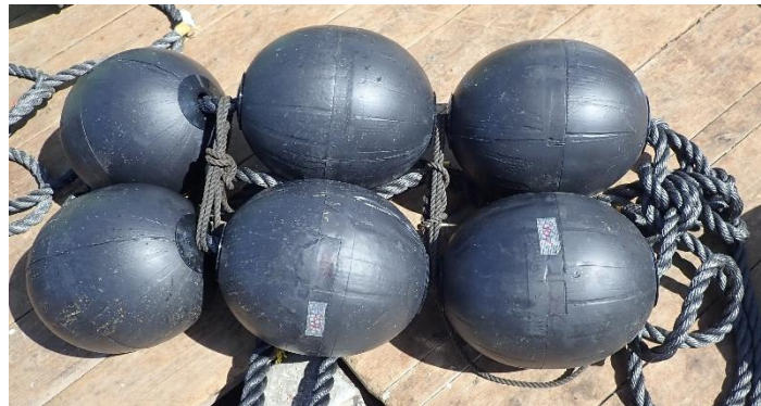
図 2-1-7 R6 型 PLA フロート 6 個を使用したエコ FADs の浮体
