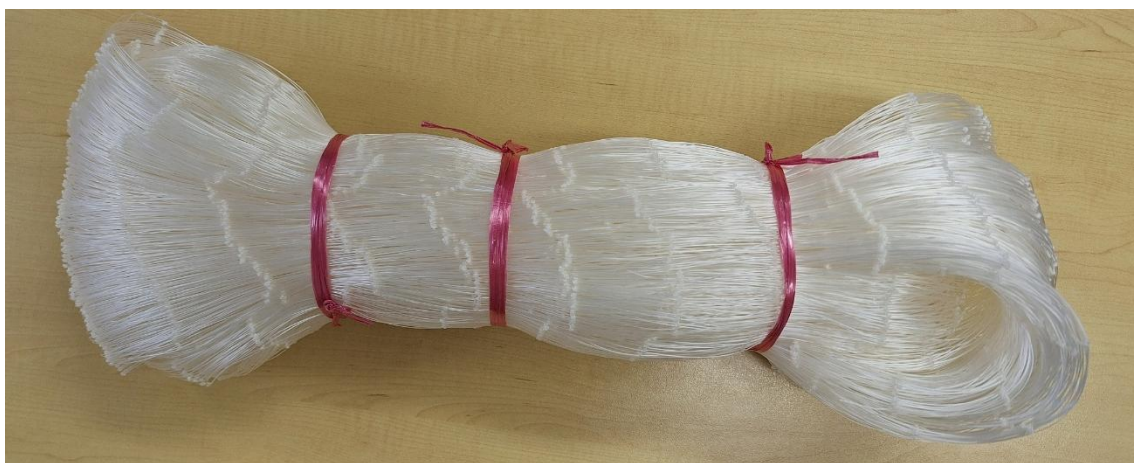
図2-4-1 令和5年度に試作した PLA 製モノフィラメント刺網
