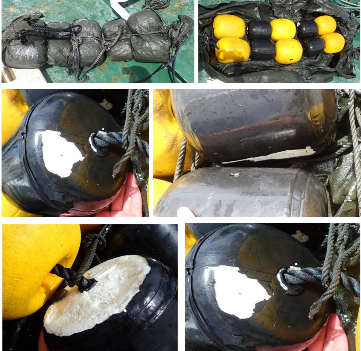
図 2-1-8 点検した R5 型 PLA フロート(漂移 46 日)
