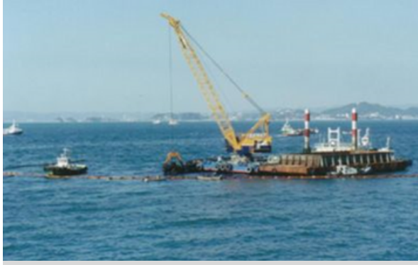
左：クレーン台船システム（グラブ船、押船、ボックスバージ、曳船等） 右：バケットグラブ（容量4m 3 ）で高粘度化した油を回収
